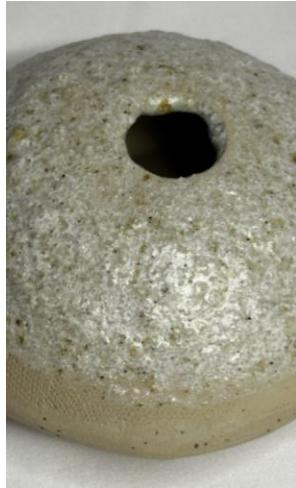
Nel secondo smalto, composto interamente da polvere di marmo, l'elevata impurità del materiale ha influenzato il processo di fusione. La polvere, infatti, non è riuscita a interagire pienamente con la silice per innescare una vetrificazione efficace, determinando così una finitura opaca e prevalentemente bianca, sebbene permangano tracce delle impurità presenti nel materiale di base.
